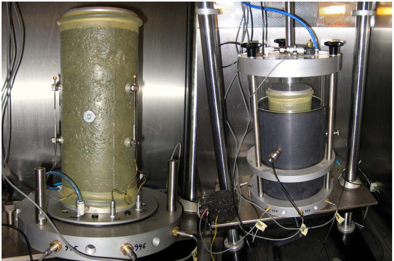
Figur 1 Triaxialprovkropp inklusive axiella och radiella givare
